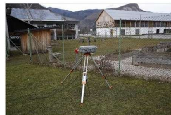
Stacionarna naprava za merjenje delcev v zraku postavljena ob osnovni šoli v Bohinjski Bistrici
