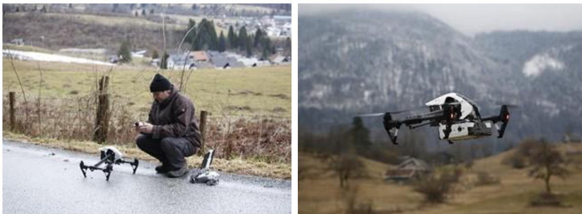
Sliki 3 in 4: Merjenje navpičnih prerezov onesnaženosti z delci z brezpilotnim letalnikom (levo) z nameščeno nizkocenovno napravo CONSPIRO (desno).
