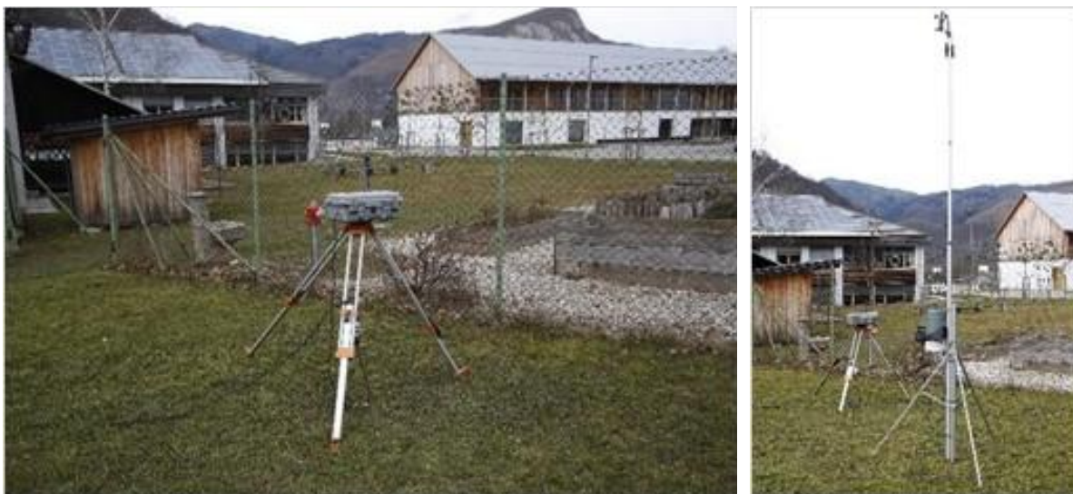
Sliki 1 in 2: Stacionarna naprava za merjenje delcev v zraku (levo) ter vremenska postaja (desno), postavljena ob osnovni šoli v Bohinjski Bistrici.
