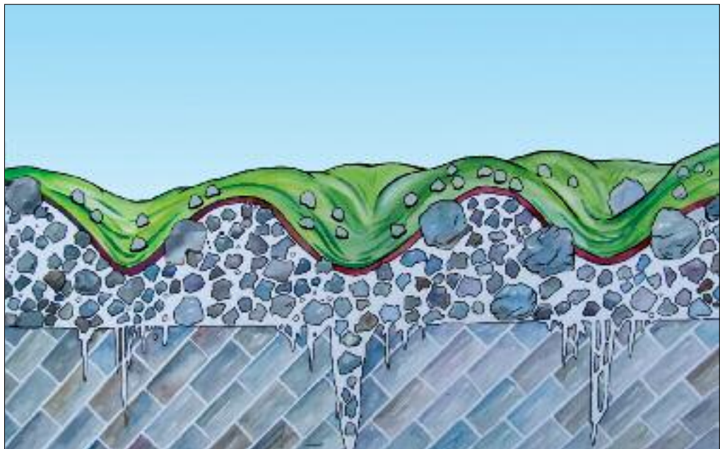
Slika 52: Shematski prikaz sufozijskih vrtač v morenskem gradivu.
