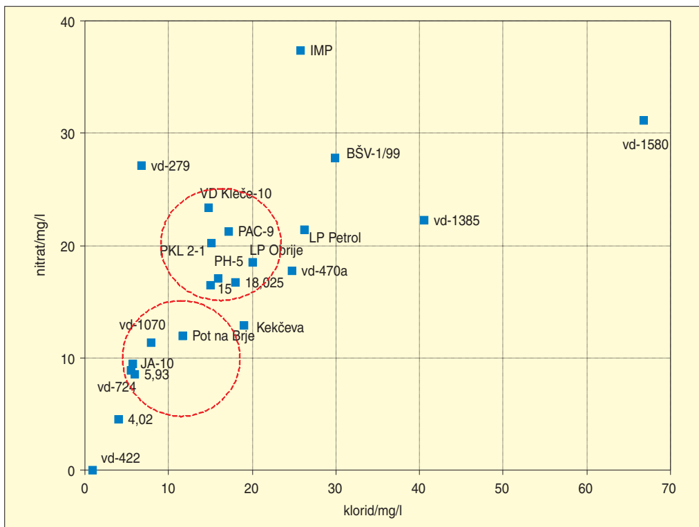
Slika 56: Povprečna masna koncentracija klorida proti povprečni masni koncentraciji nitrata.
