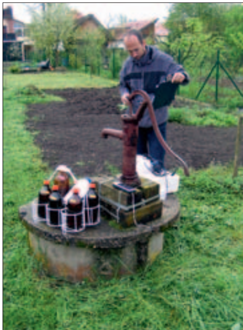
Slika 14: Odvzemanje vzorca podzemne vode iz »štirne«.
