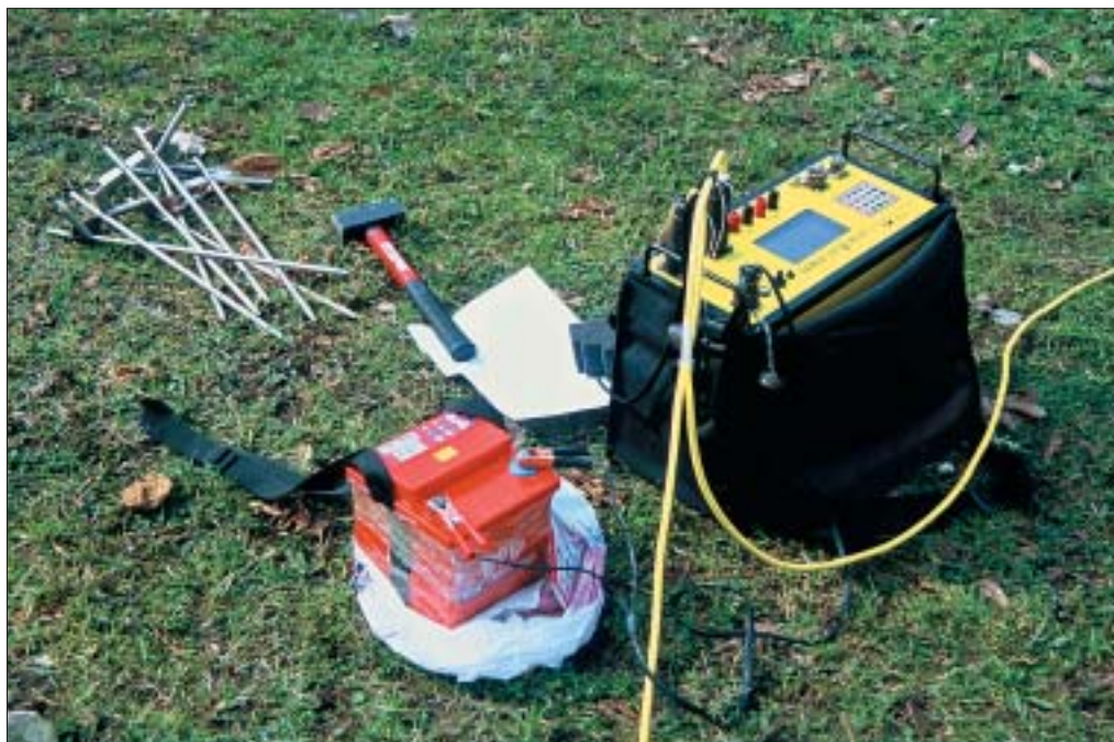
Slika 54: Merilna naprava, akumulator in kovinske palice.
