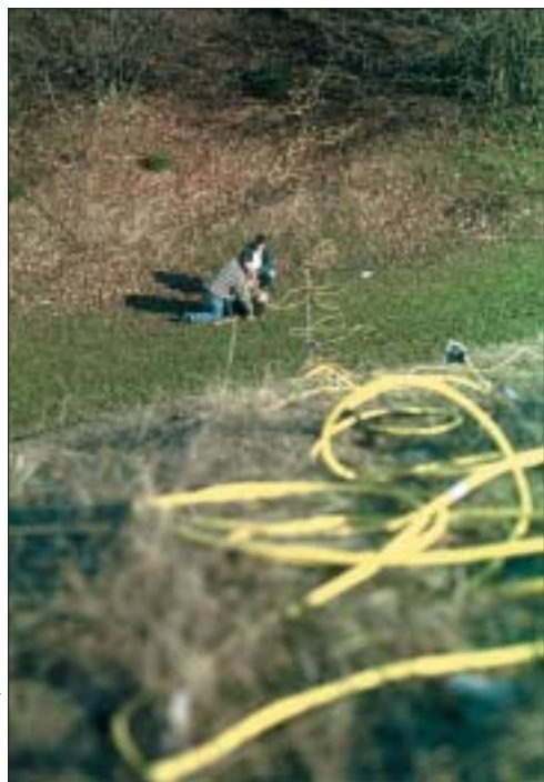
Slika 64: Električno upornost in sestavo podlage v dnu dolca smo merili z oddajno-sprejemnimi električnimi sondami, vidna je desno na sredini.
