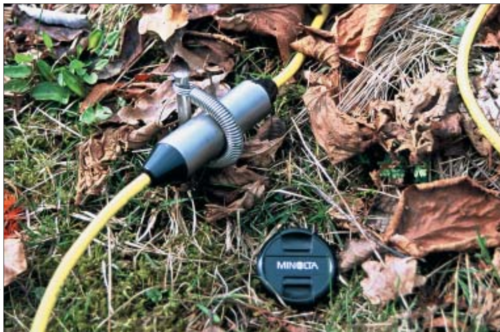
Slika 55: Elektroda je pričvrščena na kovinski stebriček.
