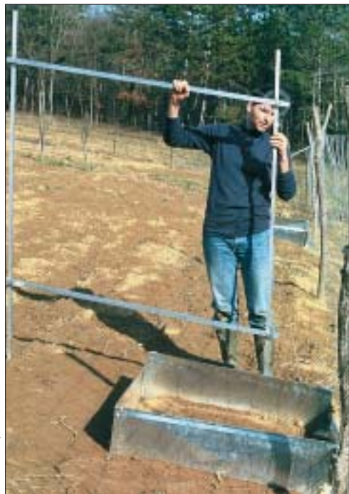
Slika 19: Pantometer sestavljata para prečno spetih aluminijastih palic. Naklon površja določamo iz naklona vodoravne palice z libelo in kotomerom, ki sta pripeta na navpično palico. Naprava je visoka 2 m in široka 1,5 m. V ospredju je na njivi erozijsko merilno polje, izdelek Matije Zorna.
