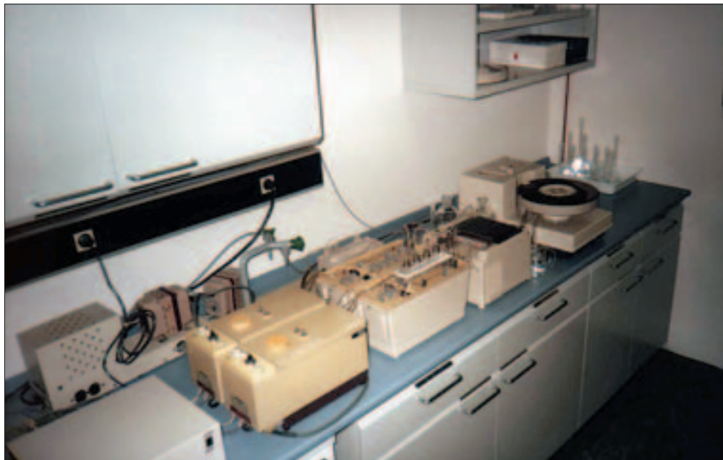
Slika 109: Aparat za določanje vsebnosti rastlinam lahko dostopnih oblik dušika (nitrat, amonij in nitrit) v tleh.
