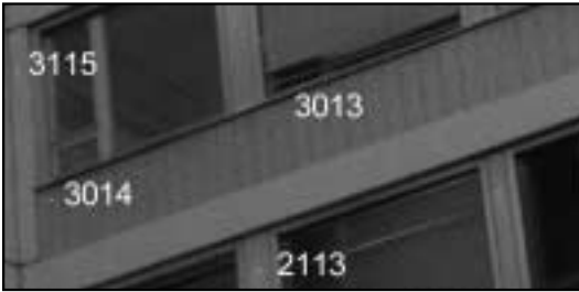
Figure 3: Retroreflective points in the test field at the Technical University of Vienna. Photo from calibration procedure. Slika 3: Retro-refleksivne točke v testnem polju dunajske tehniške. Fotografija iz postopka kalibracije.
