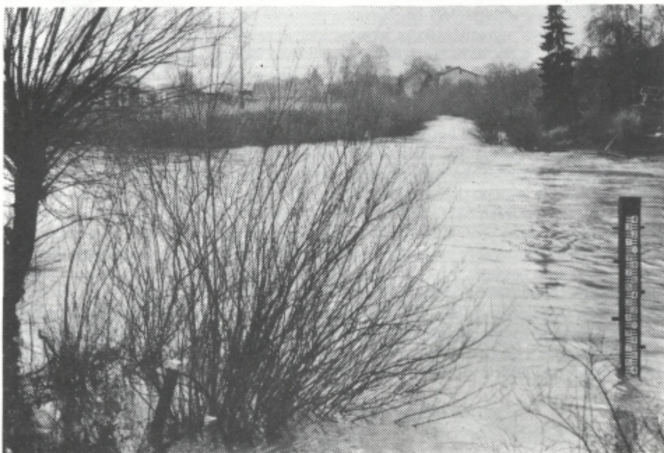
Sl. 1. Izliv Malega grabna v Ljubljanico. Na desnem bregu Ljubljanice merilna letev. Višina vode 30. 12. 1978 H=338 cm.
