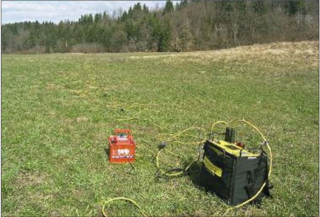
Slika 40: Naprava za merjenje električne upornosti tal, povezana z električnimi kablji, elektrodami in akumulatorjem.
