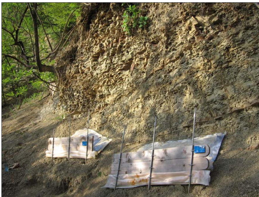
Slika 4: Erozijski polji za merjenje sproščanje flišnih kamnin oz. za spremljanje umikanja strmih flišnih pobočij (fotografija: Matija Zorn).
