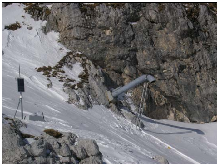
Slika 3: Sprožilec za namerno proženje snežnih plazov nad smučiščem Kanin (fotografija: Blaž Komac).
