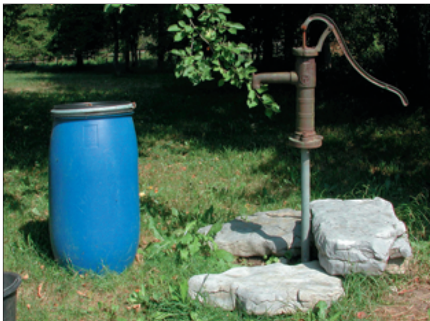
Slika 30: Za črpanje podtalnice iz majhnih globin so primerni zabiti vodnjaki.
